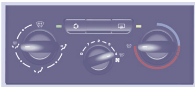
Панель управления отоплением
